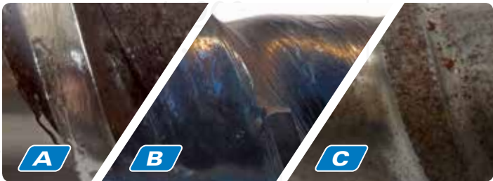
A: Adhesion B: Abrasion C: Corrosion
